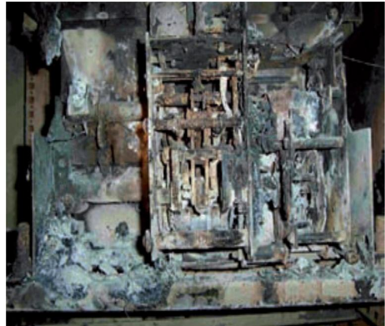
\* Fuente Allianz: Incendio en switch gear aerogenerador.
